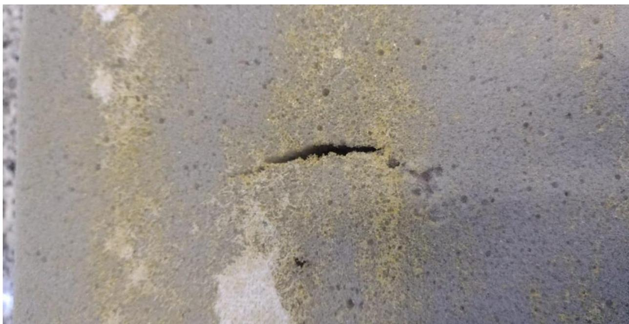
**FOTOS 6 AO 10 – FALHAS ESTRUTURIAS NO BLOCO DE ESPUMA**
