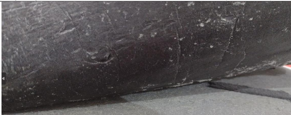
FOTOS 4 E 5 – IRREGULARIDADES NA COLAGEM E PRESENÇA DE CASCA
