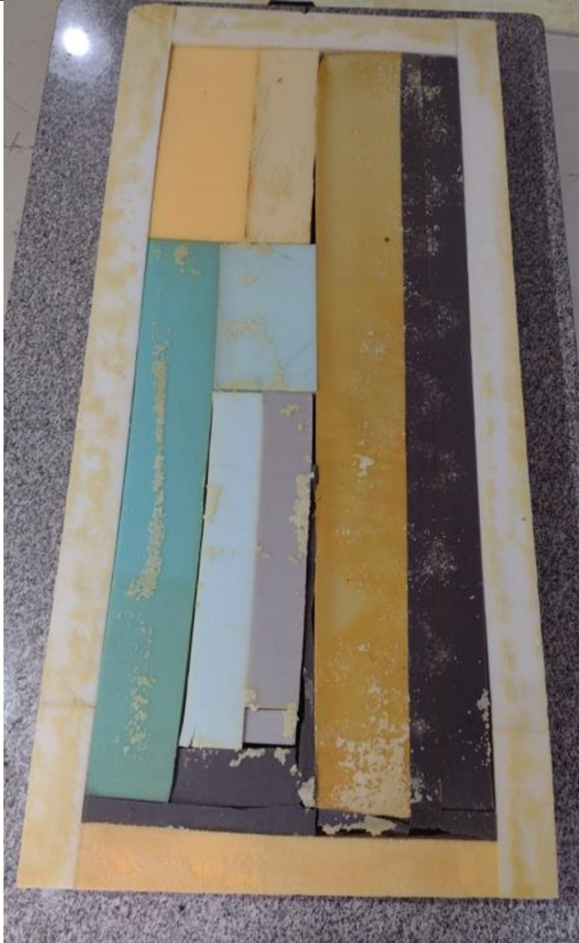
FOTOS 4 E 5 – IRREGULARIDADES NA COLAGEM
