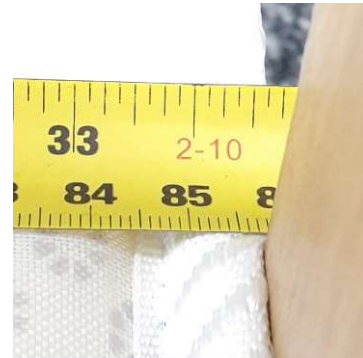
Foto (4) – Comprimento do colchão com revestimento
