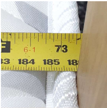
Foto (3) – Comprimento do colchão com revestimento
