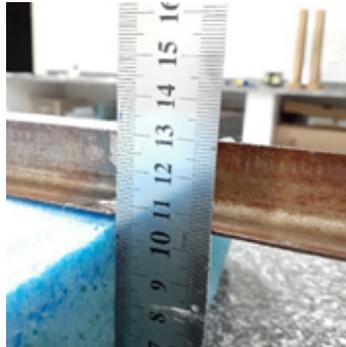
Foto (6) – Espessura da lâmina de espuma sem revestimento
