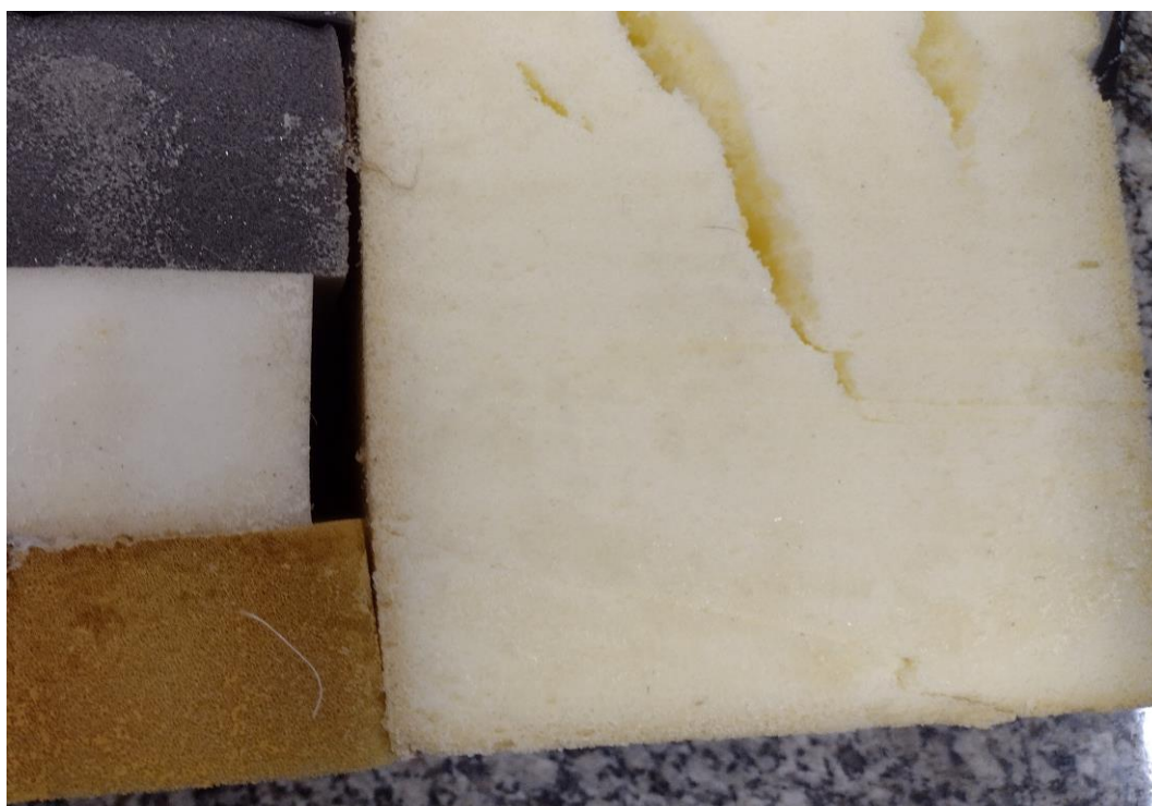
FOTOS 4 A 14 – IRREGULARIDADES NA COLAGEM E PRESENÇA DE CASCA NA LÂMINA DO COLCHÃO
